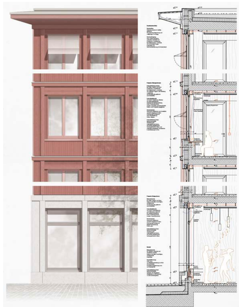
Fassadenschnitt mit Teilansicht 1:20 (Quelle: Gesamtleister 4)
